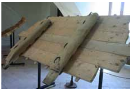
Ricostruzione di parte di uno scafo con tecnica a mortase e tenoni
